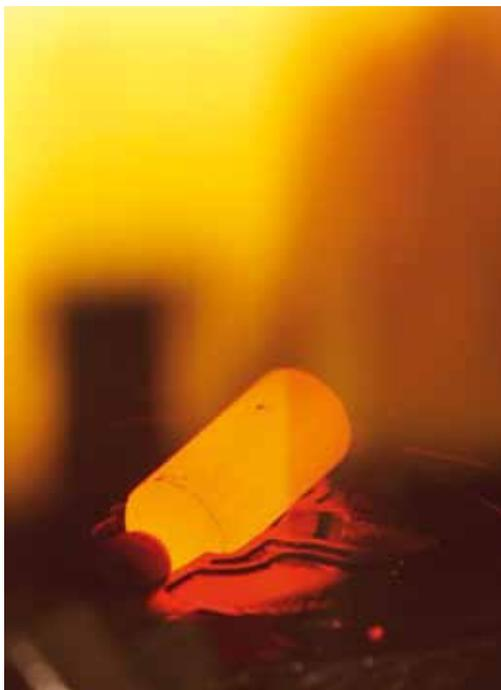
dar. Hohe Druckdichtigkeit, Festigkeit und eine schleif- und polierfähige Oberfläche zeichnen Pressteile gegenüber Gussteilen aus. Die spanende Weiterverarbeitung der Pressteile erfolgt auf modernen Rundtakt-Mehrwegeautomaten oder bauteilabhängig auf flexiblen CNC-Bearbeitungszentren.
